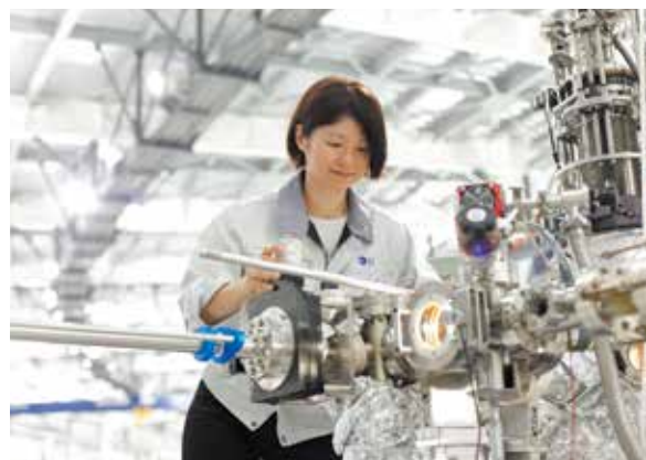
ビームラインBL06Uの分析装置を調整する北村さん。装置の外から操作棒で内部の試料のセッティングを行います。
